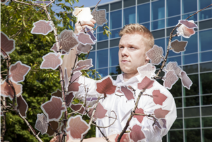
PROTOTYPE MET NIEUWE GENERATIE ZONNECELLEN, GEKLEURD, TRANSPARANT, FLEXIBEL EN VORMVRIJ.
