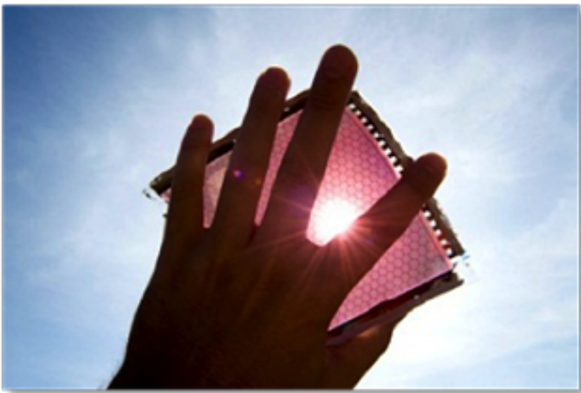
SEMITRANSPARANTE ORGANISCHE ZONNECEL ONTWIKKELD DOOR SOLLIANCE/HOLST CENTRE (FOTO: HOLST CENTRE)
